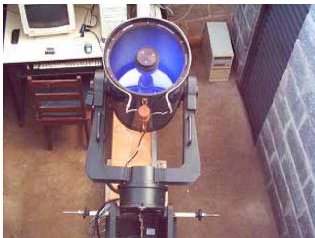
Fig2. O Meade LX200 de 12" em sua posição de parking. Ao fundo o computador que controla os equipamentos
