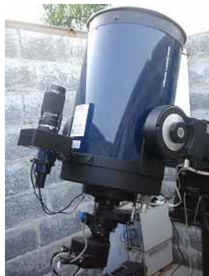
Fig5: Meade LX200, com a CCD principal conectada ao redutor focal, roda de filtros e motor ROBOFOCUS, para controle do foco
