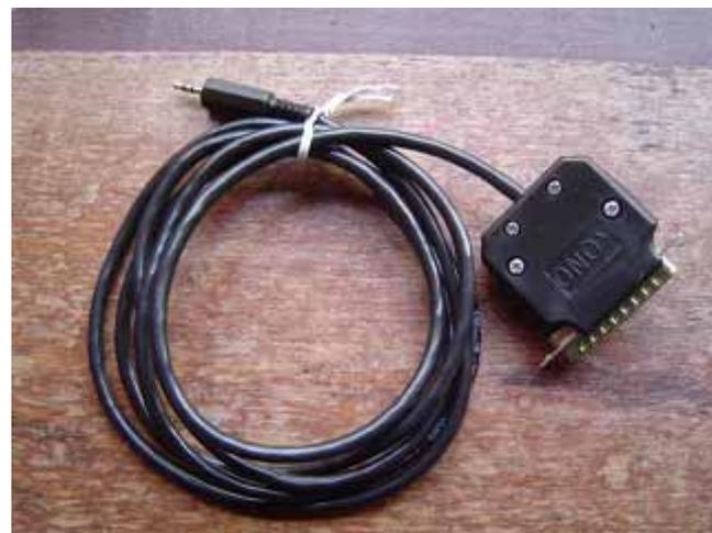
FIG 4 - Material: Pino P2, cabo de 4 vias, soquete paralelo (DB-25) com capa, 2 resistores de 2.2K 1/8W e 2 opto-acopladores 4N25. Custo total: R\$ 6,00
